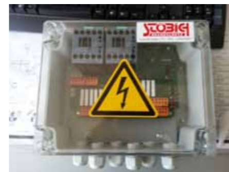
Förderantrieb-Umschaltvorrichtung für FAA-Freifahrsteuerung (UMB-U)
